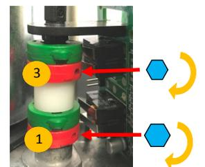
**ADJUSTING ZERO (CLOSED POSITION) LESS THAN 0°**
