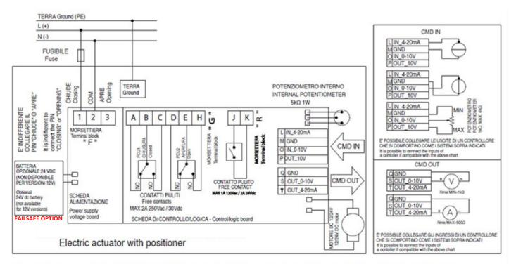
Evitare che il segnale di massa/neutro dell'alimentazione COM collegato al morsetto "2" della morsettiera "F", non sia allo stesso potenziale elettrico della massa del segnale di comando "GND" della morsettiera "CDM IN" o della massa dell'uscita di segnalazione "GND" della morsettiera "CDM OUT".
